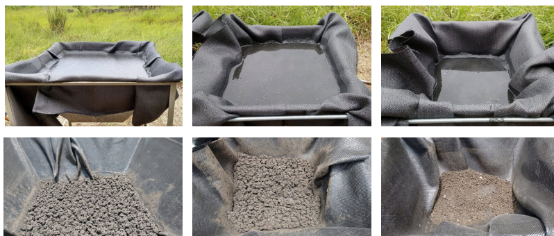
Figura 3: Ensaio de desaguamento de lodo anaeróbico em LD na fase inicial e após 21 dias.
