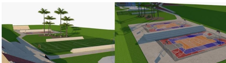
Figura 9 - Proposta de uso de lazer em bacia de detenção/infiltração
