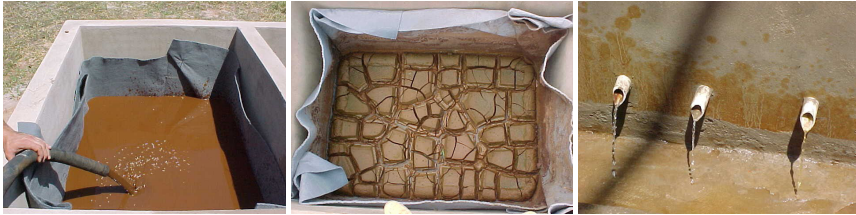
Figura 4: Ensaios de desagamento do lodo em sistemas de LD em escala piloto.
