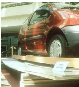
**Figura 3** – Laje (1,8 m x 3 m), constituída por UHPC de 25 mm de espessura suportando um automóvel - Fernandes(2011)
