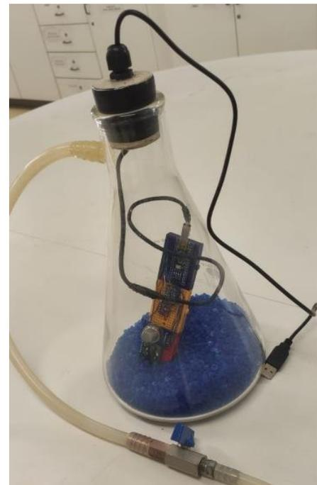
Figura 5 - Kitassato com sensores de análise de gás
