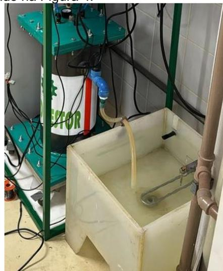
Figura 4 - Sistema de aquecimento do Biodigestor
