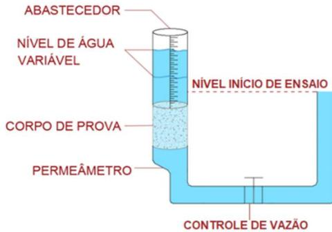
**Figura 7- Permeâmetro de carga variável**
