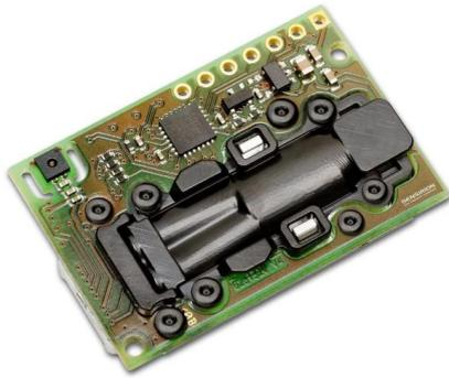
Figura 6 - Sensor SCD30 de umidade, temperatura e CO<sub>2</sub>
